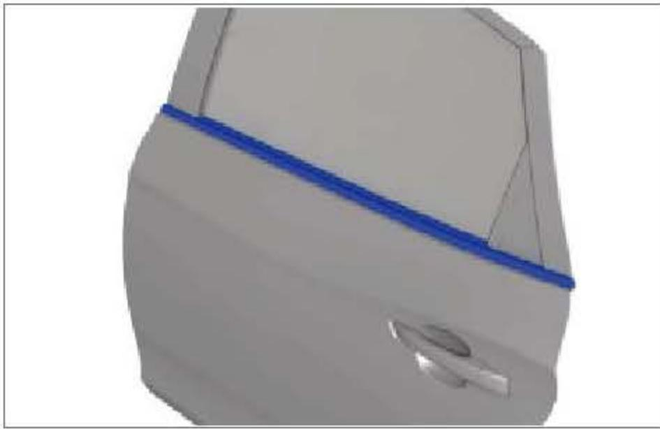
安装后车门外水切条总成。
