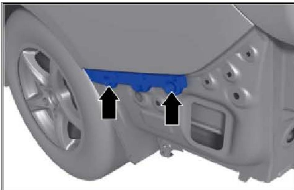
安装后保险杠左侧下部托架和 2 个螺钉。
