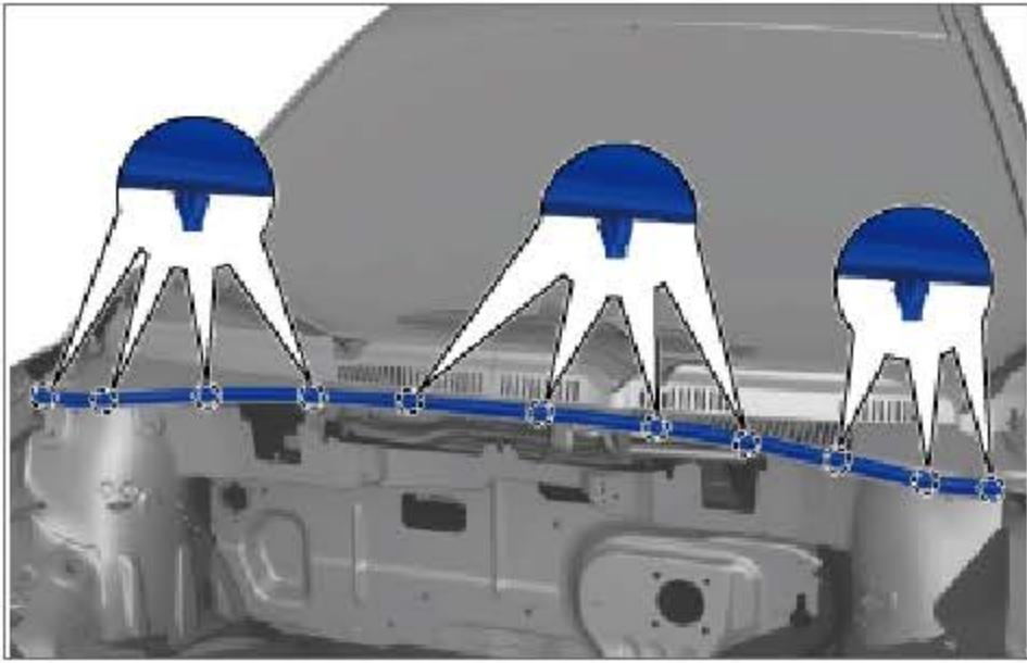
拆下 11 个卡扣和水槽格栅总成密封条。
