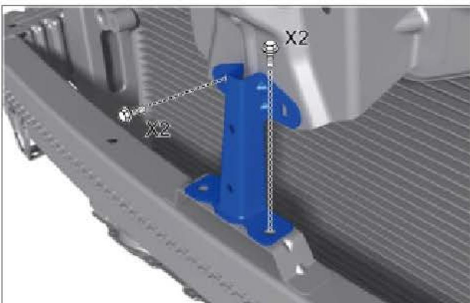
安装发动机罩锁支架，并用 4 个螺栓紧固。
