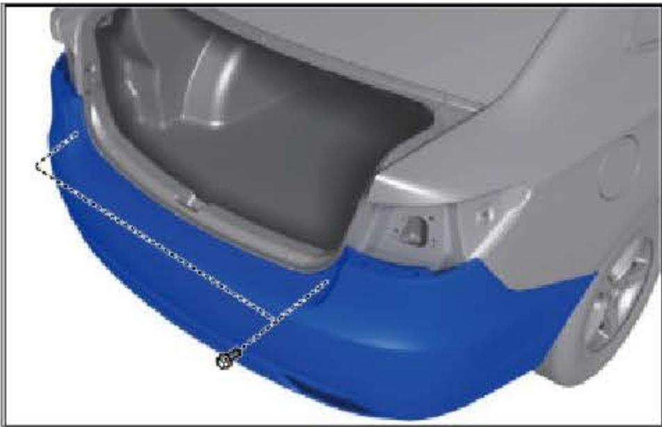
安装后保险杠总成后部的 2 个螺钉。
