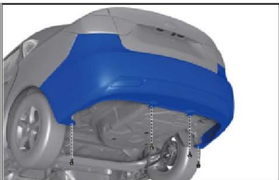
拆下后保险杠总成底部的 4 个固定螺栓。
