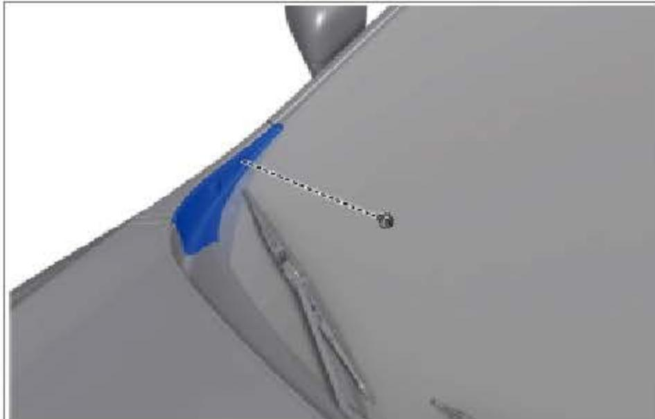
拆下卡扣，然后拆下右前翼子板装饰条。
