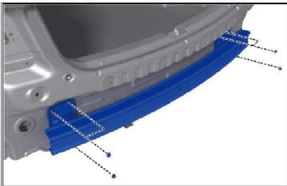
安装后保险杠横梁焊接总成并安装 6 个螺母。
