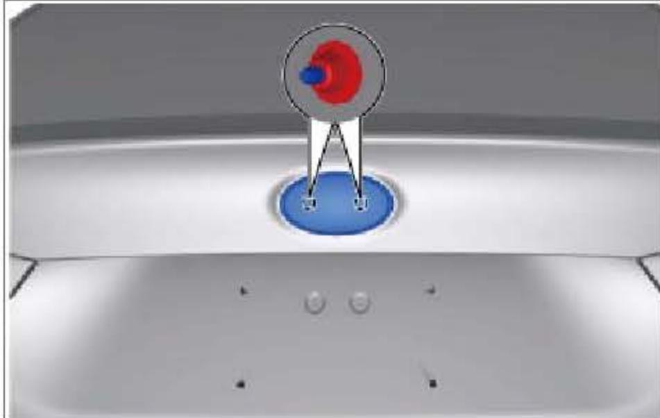
拆下卡片，并拆下后标志。
