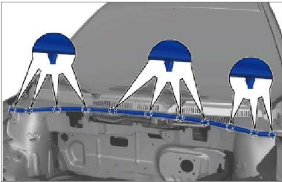
安装卡扣和水槽格栅总成密封条。
