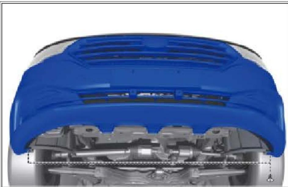
拆下左侧前保险杠底部与前轮罩防护件总成 2 个固定螺钉。
