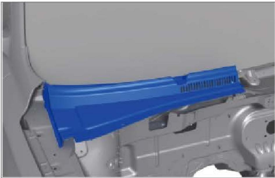
安装右侧水槽格栅总成和卡扣。
