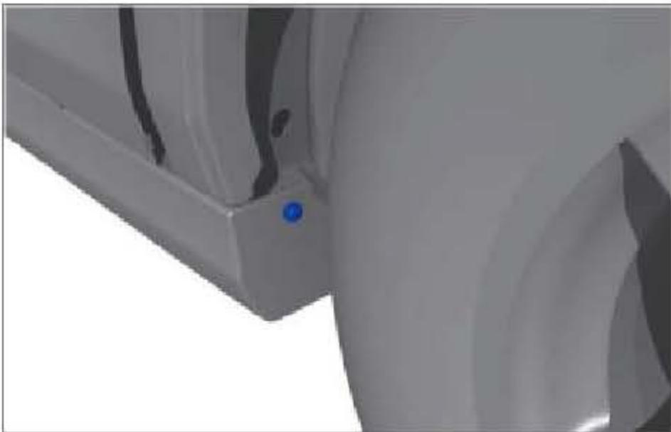
拆下门槛装饰板后部的螺钉。
