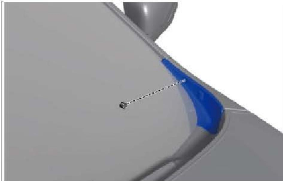
拆下卡扣，然后拆下左前翼子板装饰条。
