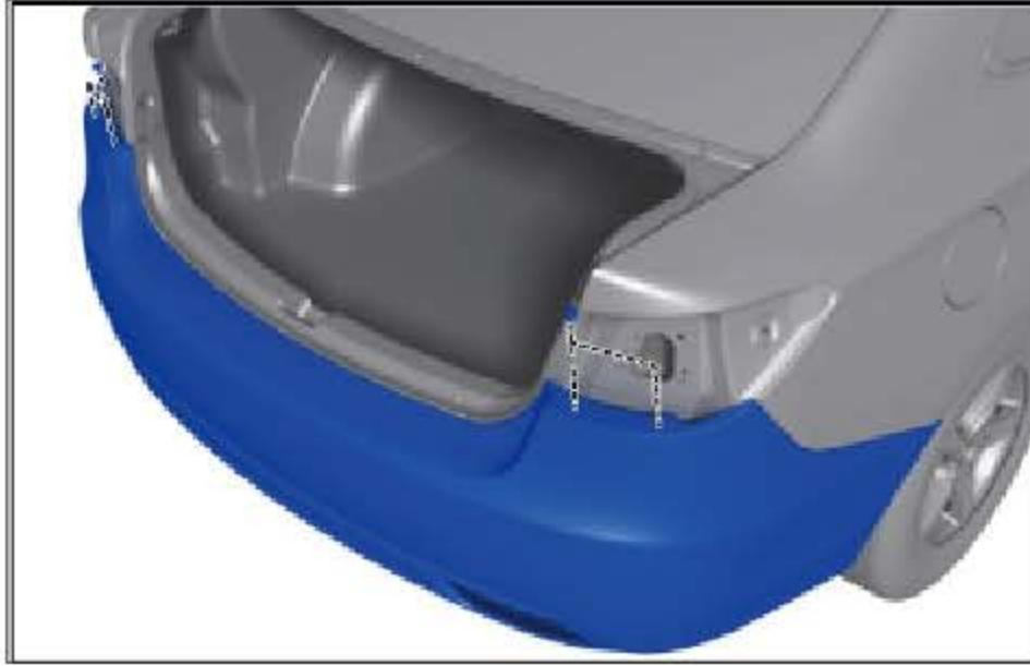
拆卸后保险杠总成上部左右两侧的固定卡扣。
