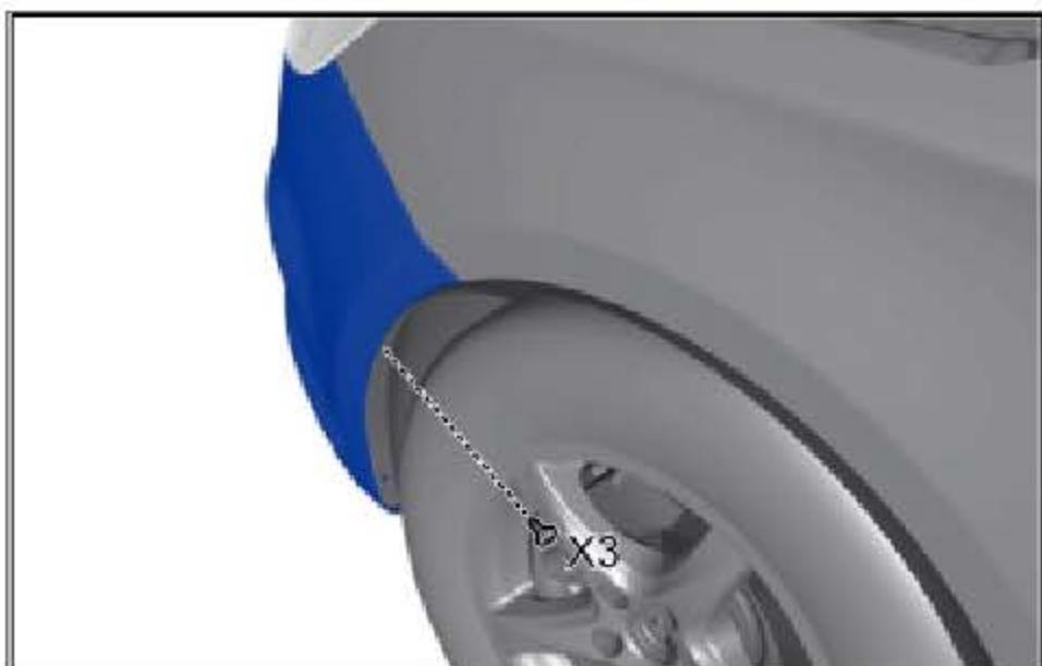
拆下左前轮罩防护件总成与前保险杠之间的 3 个螺钉。
