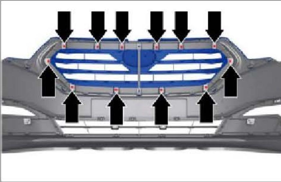
安装散热器格栅的 12 个固定螺钉。
