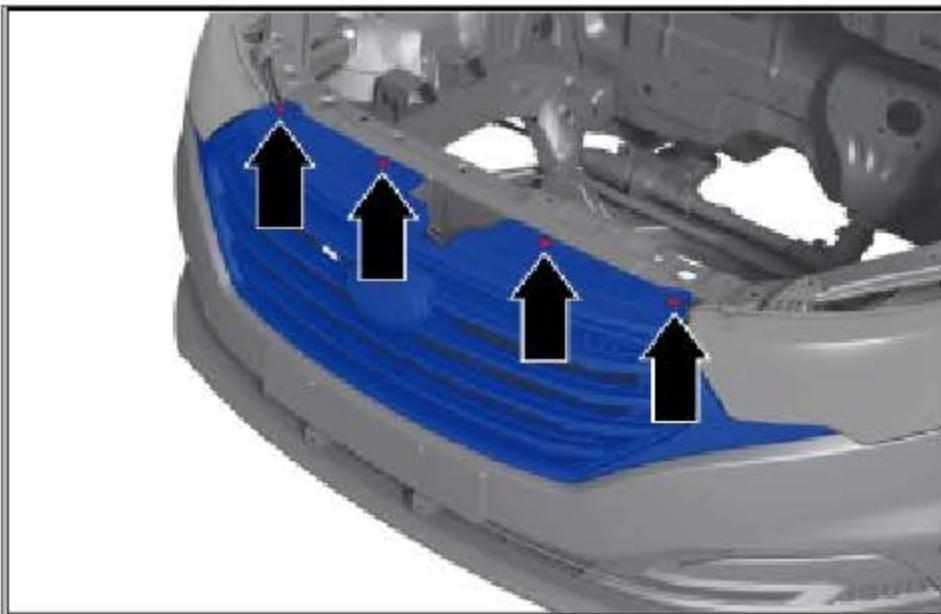
安装散热器格栅的 4 个紧固螺栓。
