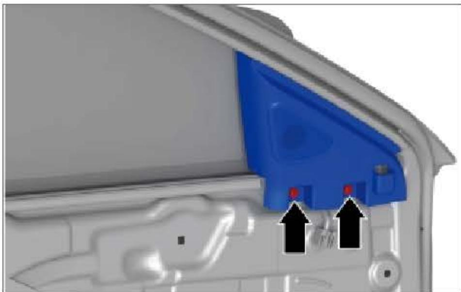
安装左前门三角盖总成的固定螺钉。
