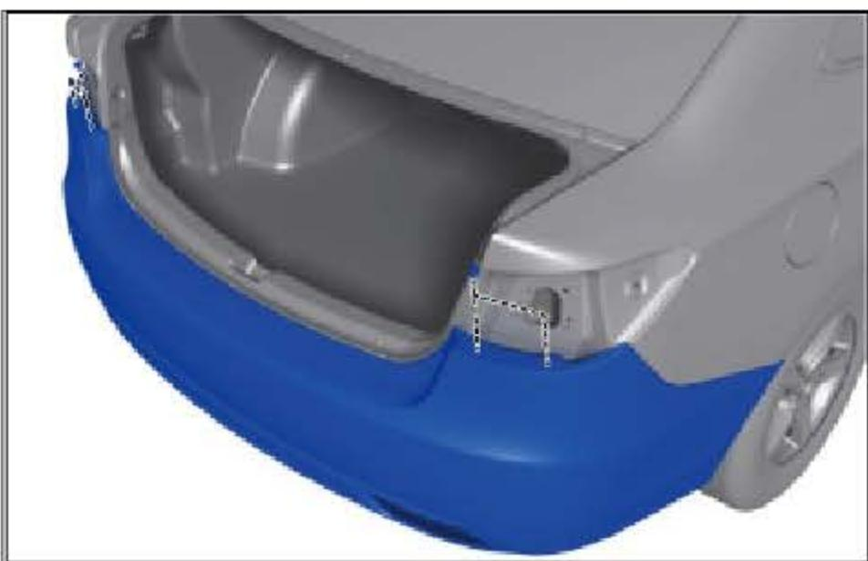
安装后保险杠总成上部左右两侧的固定卡扣。
