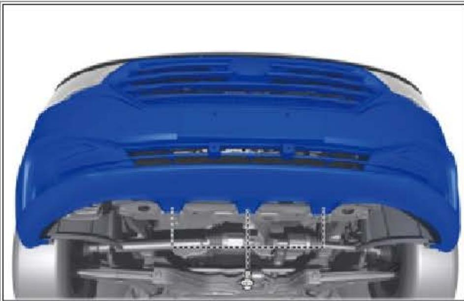
拆下前保险杠底部的 3 个螺栓。
