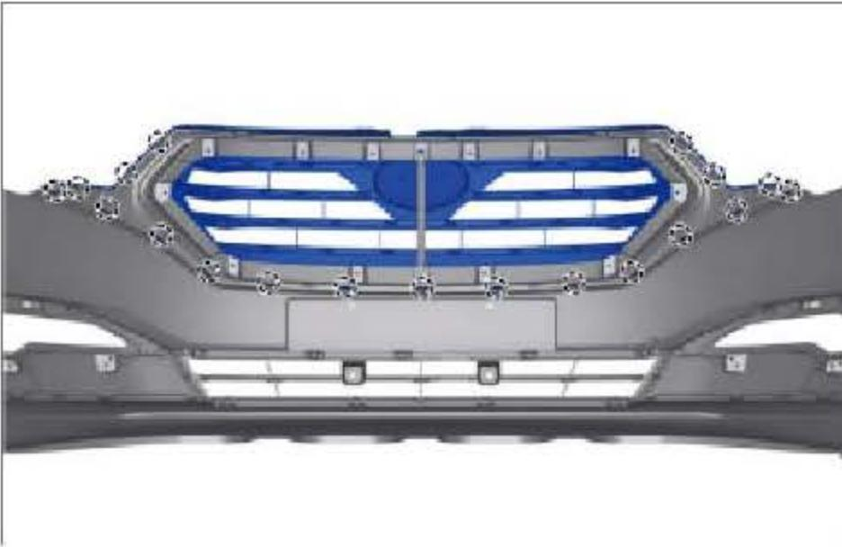
将散热器格栅总成安装到前保险杠总成上。
