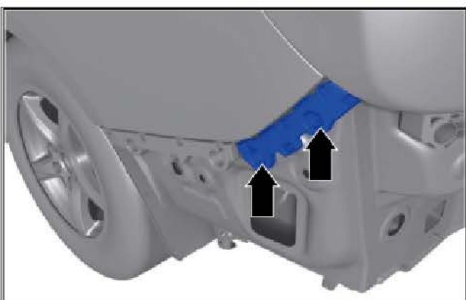
安装后保险杠左侧上部托架和 2 个螺钉。
