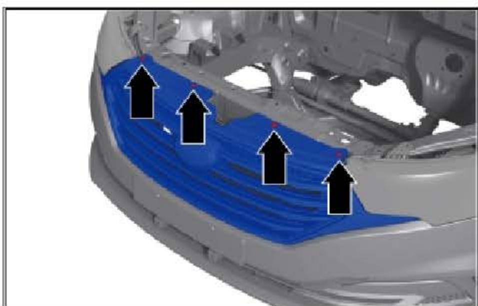
拆下散热器格栅的 4 个紧固螺栓。
