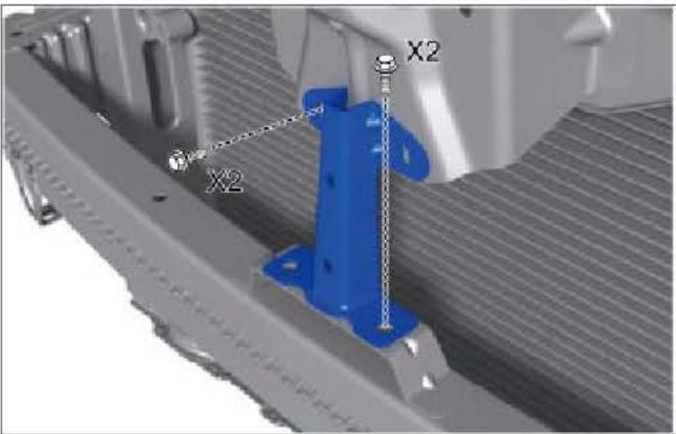
拆下 4 个螺栓，取下发动机罩锁支架。
