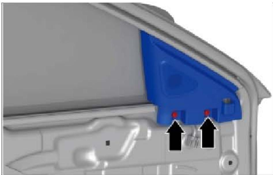
拆下 2 号扬声器的固定螺钉。
