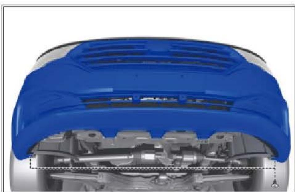
安装左侧前保险杠底部与前轮罩防护件总成 2 个固定螺钉。
