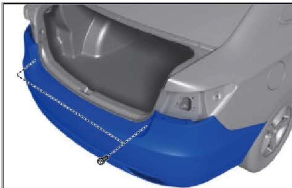
拆下后保险杠总成后部的 2 个螺钉。
